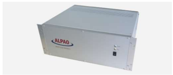
100单元以上变形镜的电子控制箱
