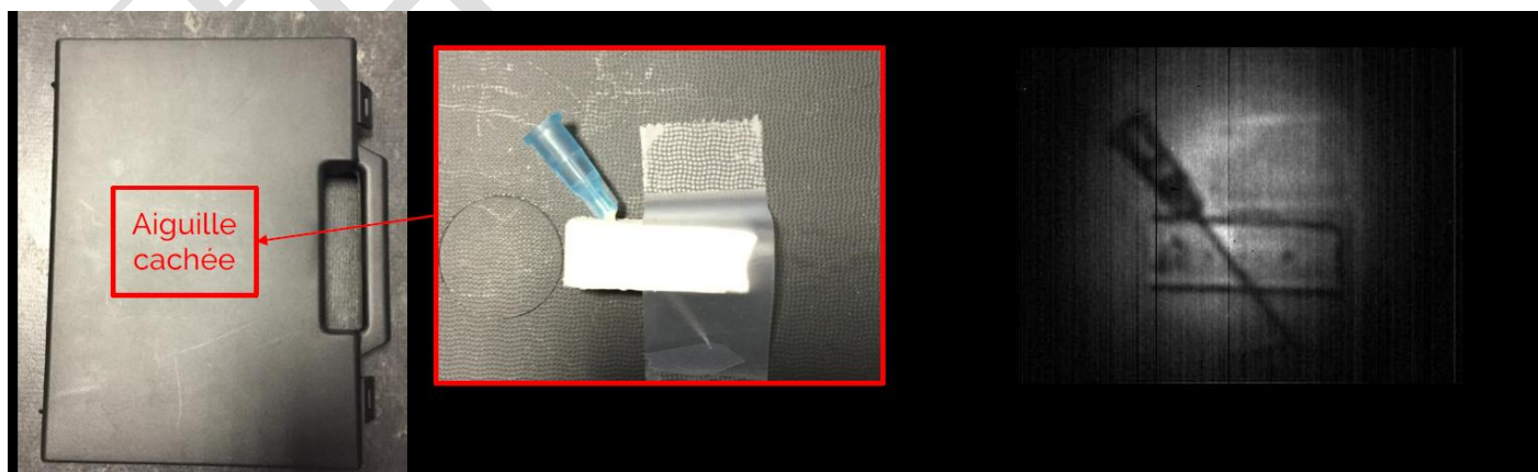
图 3: 藏匿于手提箱中的医用针, 激光频率: 0.85 THz (353 \mu\text{m} ), 成像区域: 64 \times 48 mm
