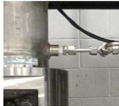
**1** 把探针插入圆规的端口(NPT, BSP, ...), 用合适的工具将其固定, 并用位移台对位置进行微调。
