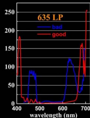
测定滤光片光谱，判定滤光片质量，区分同标号滤光片等
